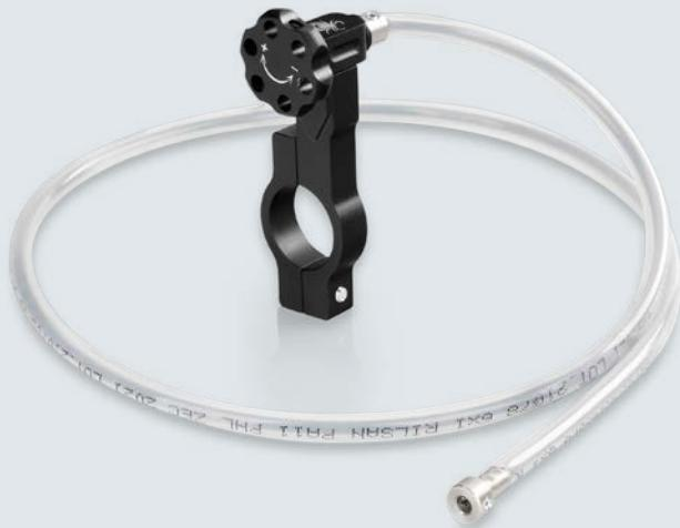
Il sistema di controllo remoto permette di regolare la corsa della pompa freno senza dover rientrare ai box. Lavorato dal pieno in lega di alluminio e trattato tramite ossidazione anodica superficiale, il controllo remoto è indispensabile per l'uso agonistico. Solitamente posizionato sul semi-manubrio sinistro consente di regolare la leva del freno direttamente con la mano sinistra.
