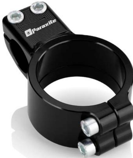
Bracciale semimanubrio off-set 42 ricavato dal pieno e con successivo trattamento di anodizzazione superficiale. Offre un'inclinazione del manubrio di 5 gradi con un'altezza del collare di 32 millimetri. Per garantire maggiore sicurezza, una vite di bloccaggio tubo ha la funzione di sicura. Compatibile con tubi da 270 mm.
