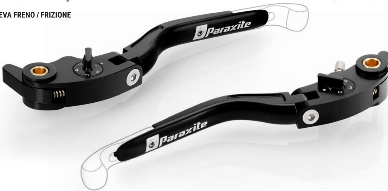
La leva STREET offre un look ricercato e la possibilità di personalizzazione tramite il finalino colorato regolabile in lunghezza. Realizzata in ergal 7075, viene lavorata dal pieno e trattata tramite ossidazione anodica dura superficiale.
