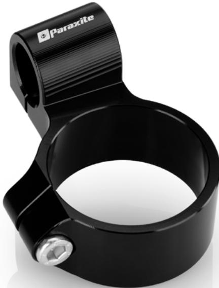
Bracciale semimanubrio off-set 50 ricavato dal pieno con successivo trattamento di anodizzazione superficiale. Offre un'inclinazione del manubrio di 6,5 gradi e un rialzo di 10 millimetri, con un'altezza del collare di 30 millimetri. Per garantire maggiore sicurezza, una vite di bloccaggio tubo ha la funzione di sicura. Compatibile con tubi da 270 mm.
